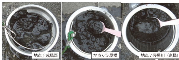
第2図 大阪市内の道頓堀川と大川で採取した河川堆積物（底質）の例。地点1（戎橋西）、地点6（淀屋橋）、地点7（寝屋川【京橋】）の試料を示す。いずれも暗黒色の浮泥である。
