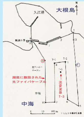
観測機器の設置図 (中海大根島入江湖岸)
