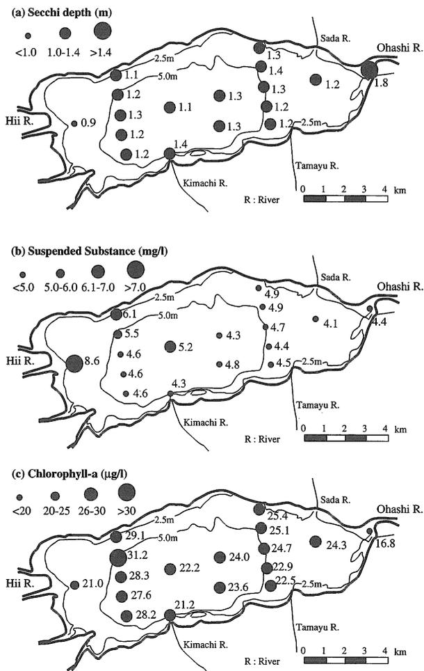
図2. 宍道湖における透明度、懸濁物質およびクロロフィル a の平均値分布(1996年). (a): 透明度, (b): 懸濁物質, (c): クロロフィル a, 調査日: 8/9, 8/13, 9/5, 10/11, 11/6. 調査時刻: 9時~11時.
