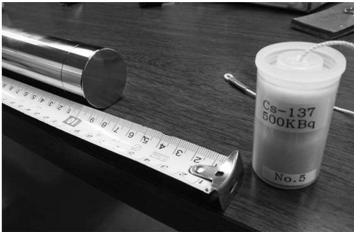
図4 シンチレーション検出器を用いた実験の様子。放射線源にはセシウム137 (Cs-137) を使用している。
