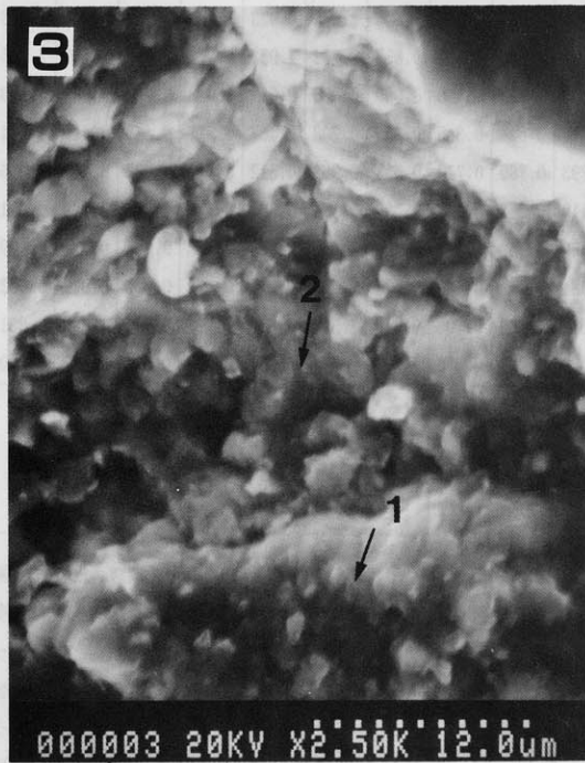
写真Ⅸ 南バルヒーエン産の漂礫にみられる岩石内に形成された割れ目とそれに析出するデザートワニス物質 (試料：88012003C)
