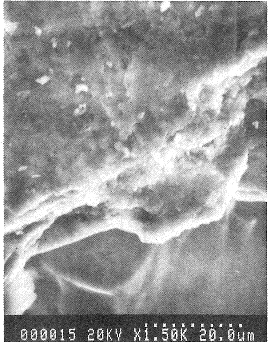
写真VI 南バルヒェン産の漂礫にみるデザートワニスの表面構造 (試料: 88012003A) 左: 礫の表面 右: 礫の表面とその直下の基質
