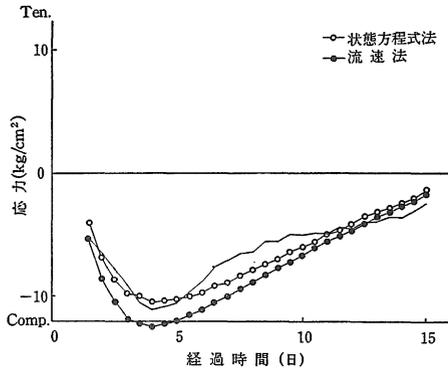
図4 温度応力解析結果（フーチング，測点3）
