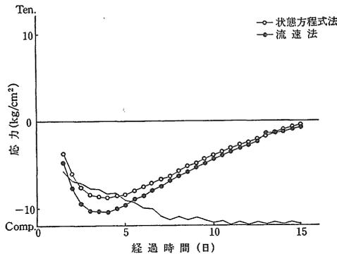
図5 温度応力解析結果（フーチング，測点4）
