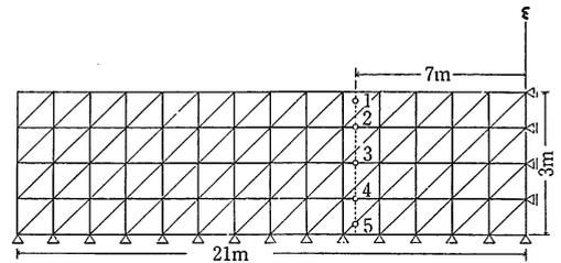
図1 フーチングの温度応力解析モデル
