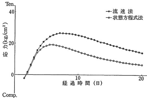
図10 温度応力解析結果（監査廊，測点5）
