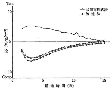
図6 温度応力解析結果（フーチング，測点5）
