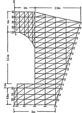
図7 監査廊の温度応力解析モデル
