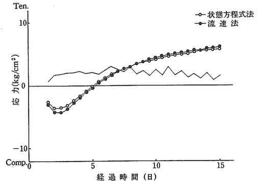
図2 温度応力解析結果（フーチング，測点1）
