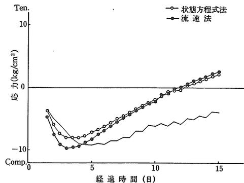
図3 温度応力解析結果（フーチング，測点2）
