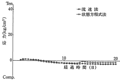
図8 温度応力解析結果（監査廊，測点1）
