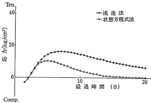
図9 温度応力解析結果（監査廊，測点3）
