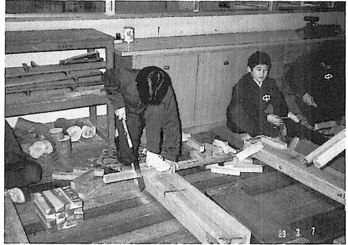
図15 のこぎりびき作業(4)両刃のこぎりによる片手びき(2)
