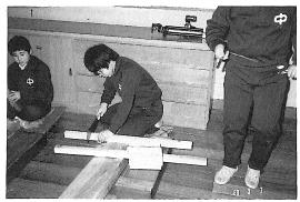
図12 のこぎりびき作業(1) 両刃のこぎりによる片手びき
