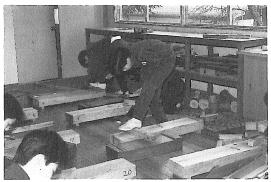
図14 のこぎりびき作業(3) 両刃のこぎりによる両手びき
