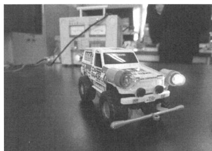
模型自動車 豆電球をゆるめるとライト OFF となる
