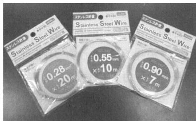
太さを変えるために用意したステンレス線 (その他 ニクロム、真鍮、鉄を用意)
